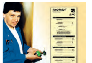
Kontrollmessung vor und nach dem Einbau
